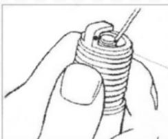
Puede limpiar la bujía con gasolina o limpiador de bujías, puede usar un cepillo para remover depósitos de carbón. No utilice navajas ni objetos metálicos filosos.
