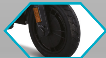
FRENO DELANTERO ELECTROMAGNÉTICO
